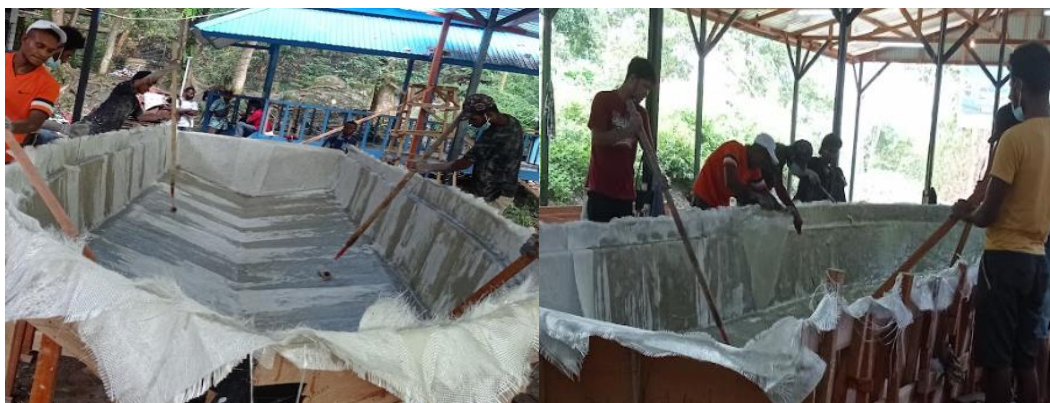
Gambar 4. Pelapisan serat fiber dan pengecoran dengan resin (9 lapisan)
