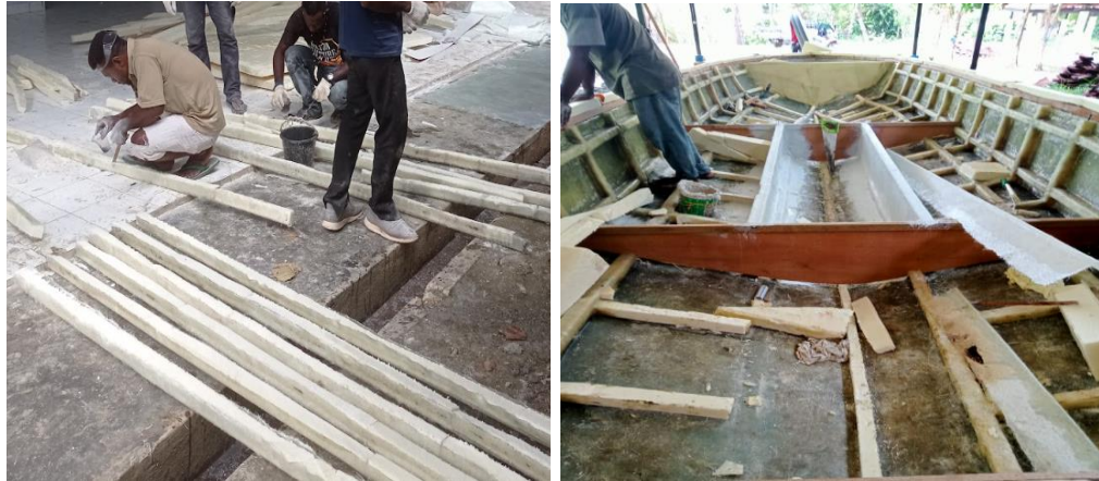
Gambar 5. Membuat rangka body bagian dan pemasangan
