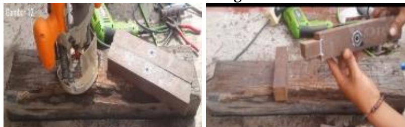
Gambar 4 Melubangi kayu dan memasukkan klaher.
